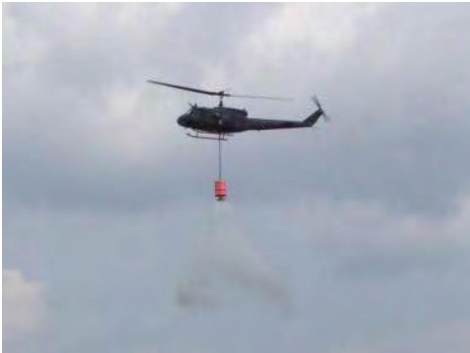
Einsatz eines Hubschrauber mit Löschwasseraußenlastbehälter
